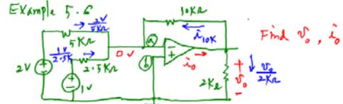
$$i_{10k} = \frac{v_0}{10k\Omega} \quad i_0 = i_{10k} + \frac{v_0}{2k\Omega}$$
